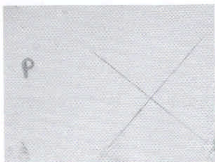
Campione P dopo 700 ore di esposizione a DCTC
